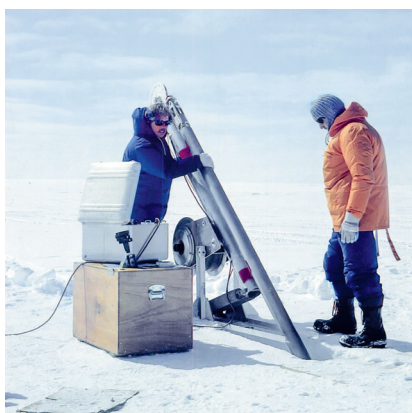
Feltarbejde i Grønland, hvor et dansk bor blev brugt til at udtage en 325 meter lang iskerne.
